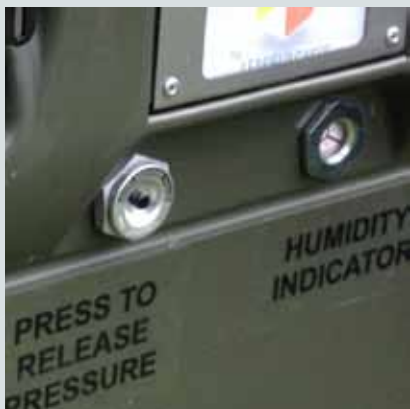
Válvulas de equilibrado de presión e indicadores de humedad
